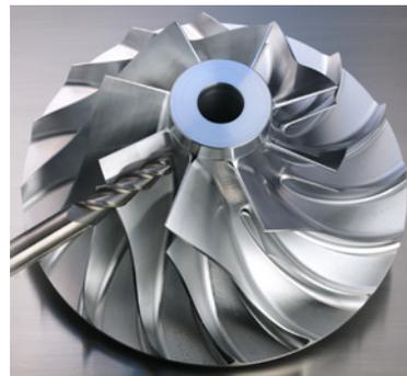
El fresado de un propulsor "blik" (disco con álabes integrados) es un ejemplo de aplicación de fresado de ángulos cerrados.
