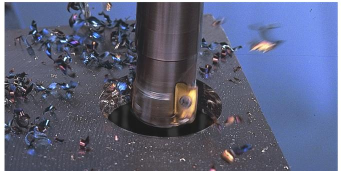
Mecanizado en rampa circular para ampliar un agujero.
