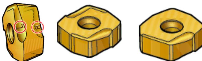
Para generar una buena superficie, es importante garantizar que el avance por vuelta ( $f_n = f_z \times z_n$ ) sea inferior al 80% de la longitud Wiper ( $b_s$ ). Naturalmente, cuanto mayor sea el diámetro de la fresa, mayor será el valor de  $f_n$ , que requiere a su vez mayor  $b_s$ .
